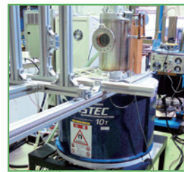
モード変換器内蔵 多周波数発振ジャイロトロン FU CW GV
